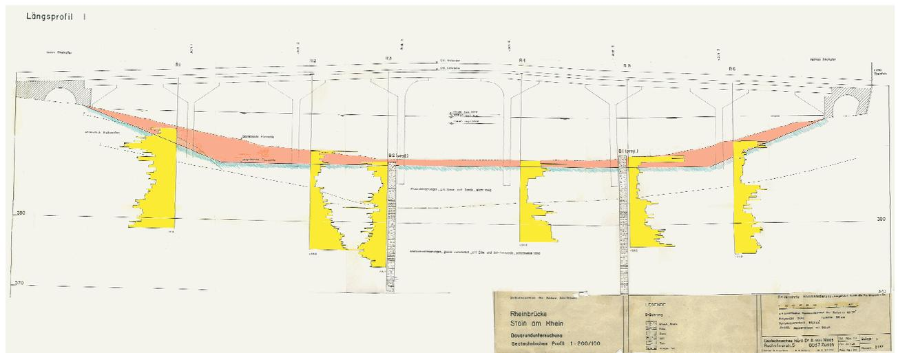
Abb. 2.5: Baugrunduntersuchung Rheinbrücke Stein, Geotechnisches Profil (November 1970) [67]
